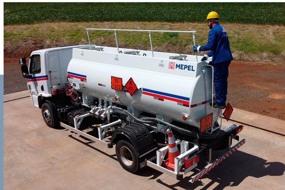
Guarda vida superior com acionamento pneumático ou manual.
