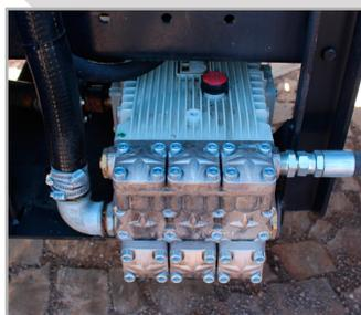
Bomba de hidrojato 130L/min (160 bar)
