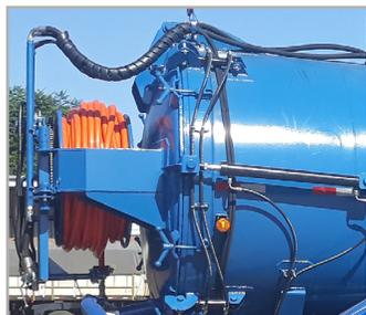
Carretel hidráulico 1" com 120m e sistema de hidrojetamento com bomba de alta pressão
