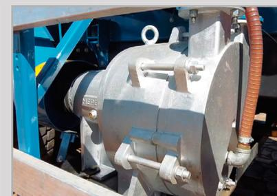
Bomba vácuo e pressão anel líquido 12 m³/min de vazão de ar
