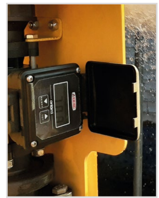
Fluxômetro: precisão na quantidade de calda incorporada
