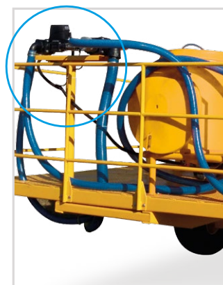
Fluxômetro: precisão na quantidade de calda incorporada
