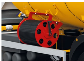
Carretel com mangueira hidráulica de 1" com 30m e bico regulável de jato/neblina.
