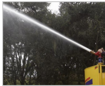
Canhão monitor com alcance de até 50 m
