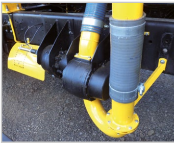
Bomba lobular 4" vazão de 60 m 3 /h e pressão de 8 kgf/cm 2
