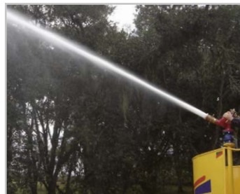
Canhão monitor com alcance de até 50 m
