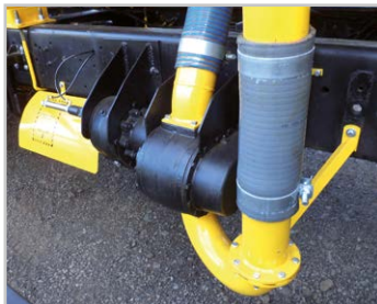
Bomba lobular 4" vazão de 60 m³/h e pressão de 8 kgf/cm²
