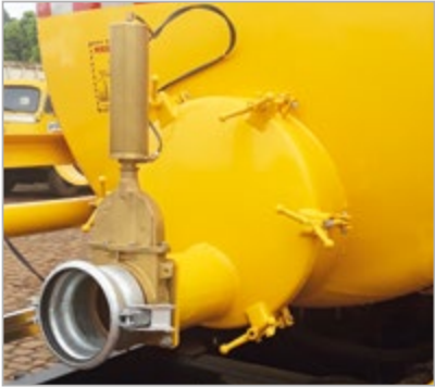
Tampa de inspeção traseira e pistão pneumático de abertura do registro
