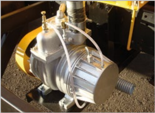
Bomba vácuo e pressão de 7 palhetas, com vazão de ar de 5,0 m³/min (300 m³/h)
