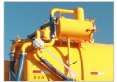
Válvulas 4 vias para carga e descarga
