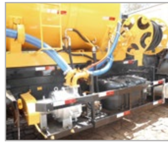
Carretel manual com mangueira hidráulica 1" com 60 m e sistema de hidrojateamento com bomba de alta pressão
