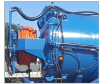
Carretel hidráulico 1" com 120m e sistema de hidrojateamento com bomba de alta pressão
