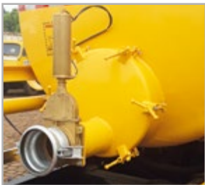
Tampa de inspeção de 550 mm e pistão pneumático de abertura do registro
