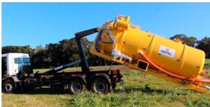
DAOL Cami com acionamento da Bomba Anel Líquido por motor hidráulico acionado através da bomba hidráulica do Roll On/Off com trocador de calor.
