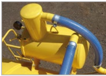
Sifão (válvula para evitar que resíduos entrem na bomba)
