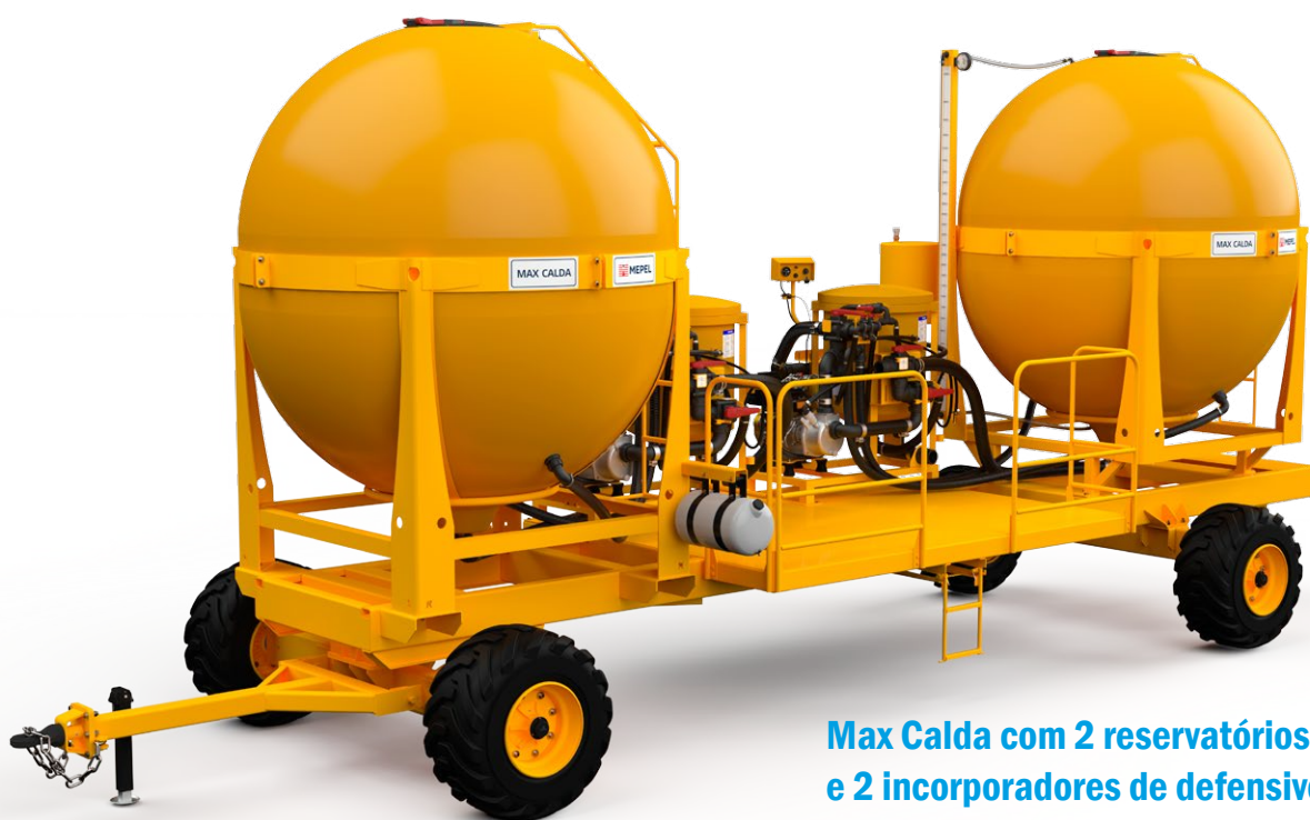
MAX CALDA 10000 L 2 ERS Aro 15,5" (2 esferas de 5000 L cada)
