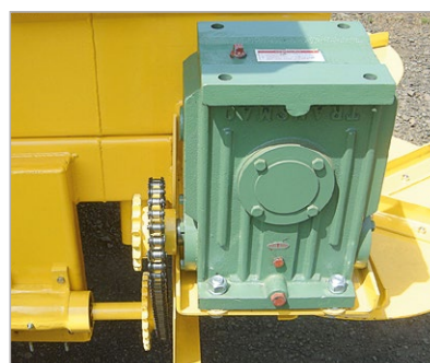
Caixa de transmissão da esteira.
