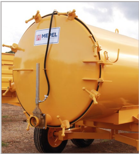
Tampa traseira de inspeção com abertura total
