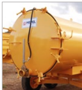
Tampa traseira de inspeção com abertura total
