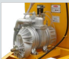
Bomba vácuo compressor 4 palhetas. Opcional: Bomba vácuo compressor 7 palhetas
