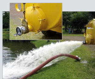
Mangueira de carga 6" e registro de gaveta hidráulico 6"
