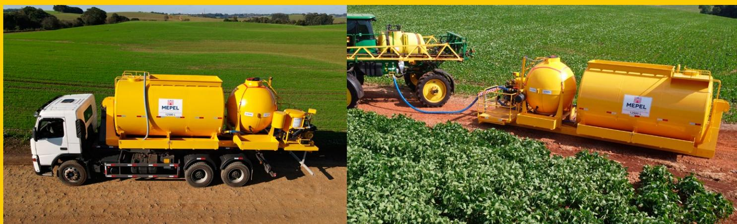
ABAPU Roll On/Off 12.500 Max Calda: reservatório 3.500 litros para calda pronta e incorporador de defensivos IDM Max.
