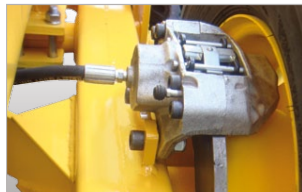
Sistema de freios instalado em eixo tandem aro 16"
