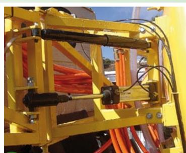
➔ Sistema pneumático de acionamento das barras
