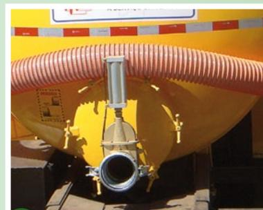
➔ Tampa de inspeção de 550 mm com mangueira de carga de 6"
