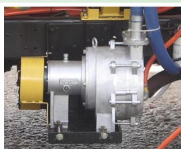
➔ Bomba vácuo e pressão de anel líquido de 8 m<sup>3</sup>/min ou 12 m<sup>3</sup>/min vazão de ar
